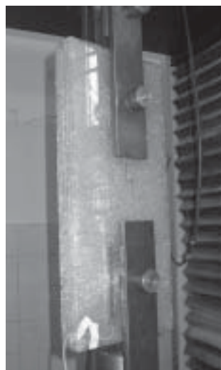
17-18. ábra. Furatlyukon terhelt edzett üveg húzási kísérlete (BME Építőanyagok Tanszék, Salem G. Nehem tudományos munkatárs vezetésével)
