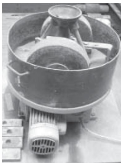
3. ábra. A Kerámia- és Szilikátmérnöki Tanszéken használt laboratóriumi görgőjárat
