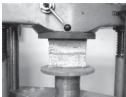
3. ábra. A nyomószilárdság vizsgálata
