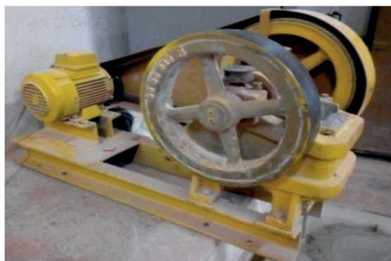
Fig. 1 Stages of elaboration and preparation of recycled gravel: 1/- Breaking up the blocks of material used with a hammer. and breaking up the material fragments to dimensions suitable for the opening of the crusher, 2/- Crushing of fragments using a two-jaw crusher, 3/- Screening procedure (separation of the different granular classes 3/8 and 8/16) 1. ábra Az újrahasznosított kavics feldolgozásának és előkészítésének szakaszai: 1/- A felhasznált anyag tömbök törése kalapáccsal és az anyagdarabok aprítása a törőgép nyílására alkalmas méretűre, 2/- A darabok aprítása kétpofás törőgéppel, 3/- Szitálás (a különböző szemcseméretű - 3/8 és 8/16 - frakciók szétválasztása)
