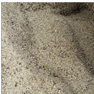
Fig. 3 Used quartz sand 0-4 mm particle size 3. ábra Az alkalmazott kvarchomok 0/4-es frakció
