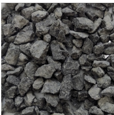
Fig. 2 Used crushed andesite aggregate 4/8 mm particle size 2. ábra Az alkalmazott andezitűszalék 4/8-as frakció
