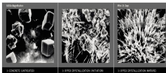
Fig. 2 Stages of crystallization of concrete 2. ábra A beton kristályosodásának szakaszai
