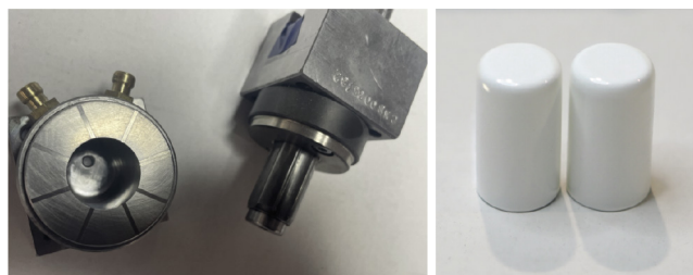
10. ábra A kísérleti termékhez használt fröccsöntő szerszám és a már elkészült termék Fig. 10 The injection molding tool used for the experimental product and the finished product
