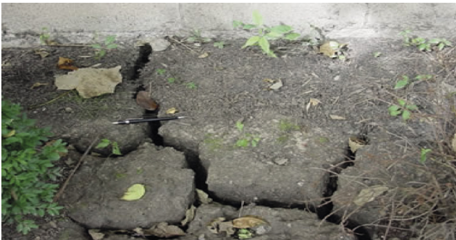
Fig. 3 Surficial cracks in expansive soil 3. ábra Felületi repedések expanzív talajban
