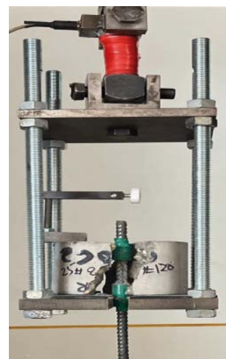
Fig. 10 Splitting failure of pullout cylinder specimen 10. ábra Hengeres próbatest hasadási tönkremenetele kihúzó vizsgálatnál
