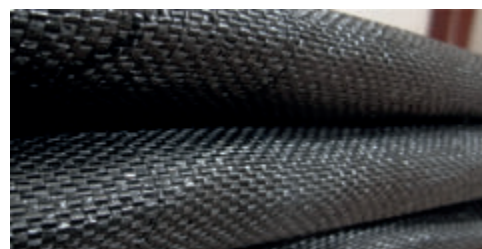
Fig. 4 Example of Woven Geotextiles 4. ábra Példa szövött geotextíliákra
