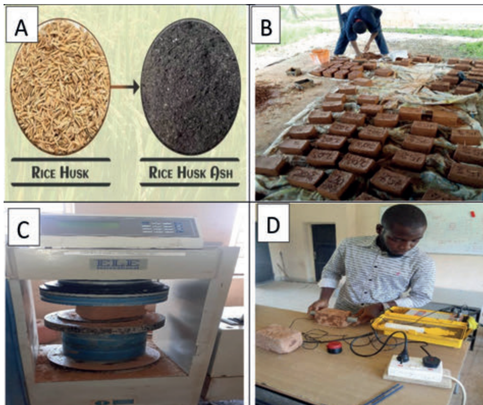
Fig. 3 (A) Rice husk and rice husk ash (B) Casted earth block samples (C&D) Earth block samples during testing 3. ábra (A) Rizshéj és rizshéjhamu (B) Öntött földtégla minták (C&D) Földtégla minták vizsgálat közben
