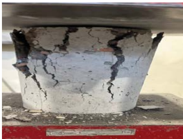
Fig. 6 Compression strength test 6. ábra Nyomószilárdság vizsgálat
