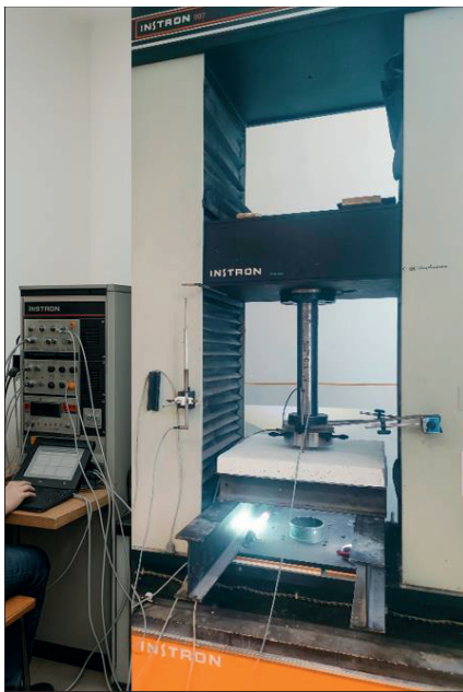
Fig. 5 Punching shear test of flat slabs 5. ábra Síkfödémek átszúródási nyíróvizsgálata
